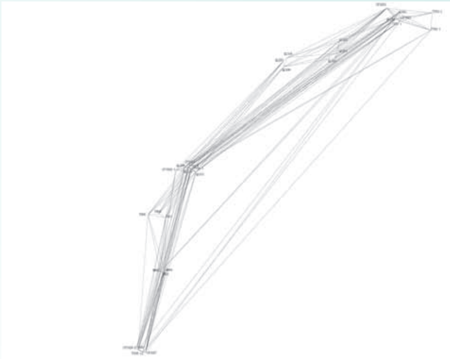
图 2 清凉、纸坊一号隧道进、出口间联系子网示意图
