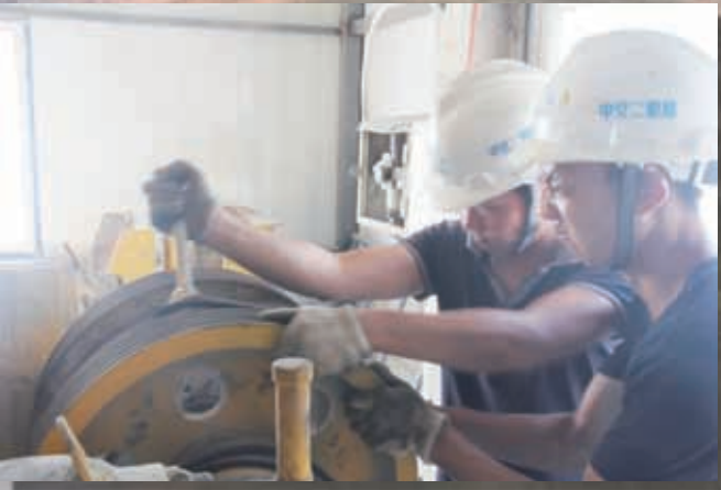
搅拌站主机检修
